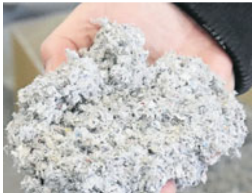
Der Labortest beweist: Cellulosedämmstoff ist gegen Schimmel immun. Die Sporen zeigen auf dem Pflanzenfasermaterial keinerlei Wachstum.
